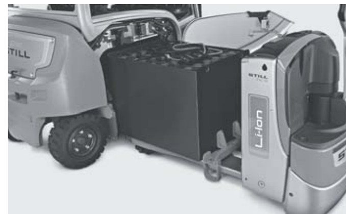
Cambio de batería con transpaleta eléctrica
