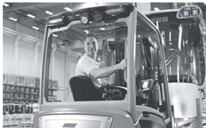
Asiento orientable hacia la parte trasera y cambio de agarre en el asidero
