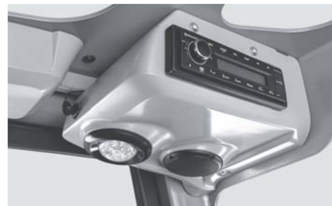
Luz de lectura y radio con sistema de manos libres y altavoces
